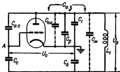
Рис. 9. Схема моста по промежуточной частоте.
