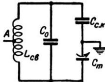
Рис. 13. Резонансный контур на катушке обратной связи гетеродина в цепи сетки.
