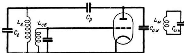
Рис. 6. Схема паразитного возбуждения на дециметровых волнах.
