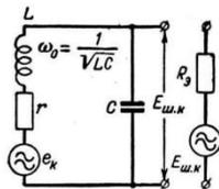
Рис. 23. Эквивалентная шумовая схема контура.
