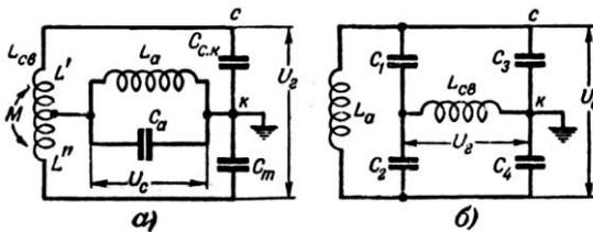
Рис. 3. Две схемы высокочастотных мостов.
