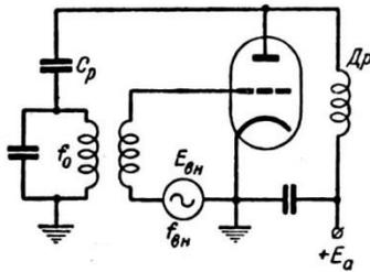
Рис. 14. Принципиальная схема захватывания автогенератора.
