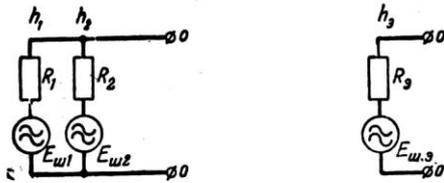
Рис. 28. Эквивалентная шумовая схема параллельно соединенных сопротивлений.
