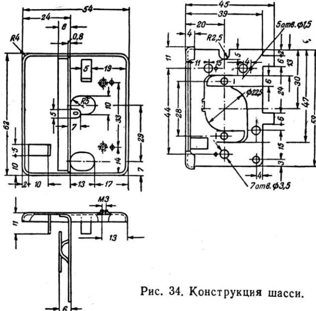
Рис. 34. Конструкция шасси.
