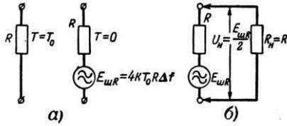
Рис. 22. Эквивалентная шумовая схема сопротивления.
