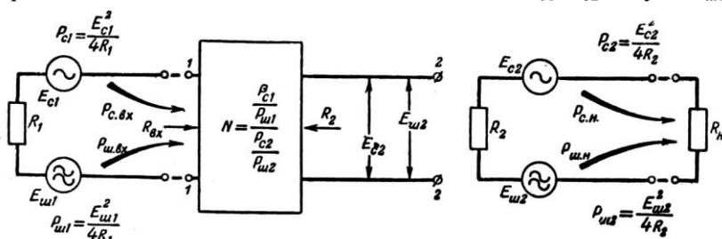
Рис. 25. Блок-схема линейного четырехполюсника для расчета коэффициента шума  $N$ .
