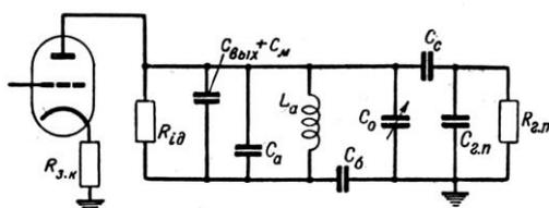
Рис. 19. Эквивалентная схема анодной цепи усилителя ВЧ.
