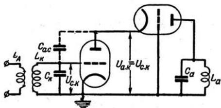
Рис. 17. Каскадная схема.
