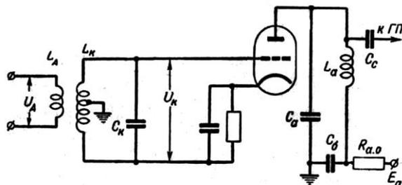
Рис. 18. Общая схема усилителя ВЧ.
