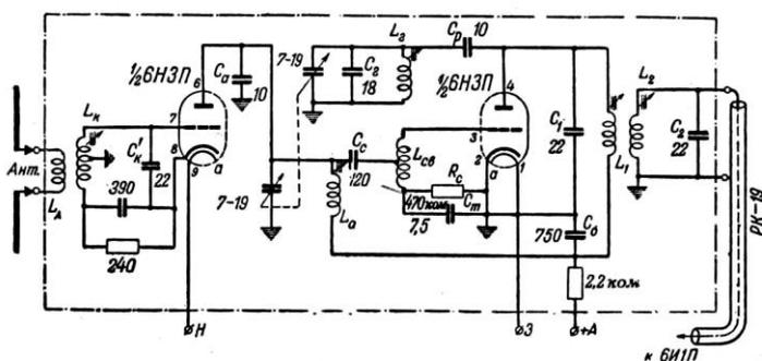
Рис. 32. Принципиальная схема макета УКВ блока.
