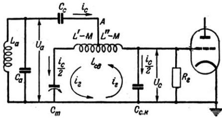
Рис. 12. Эквивалентная схема сеточной цепи гетеродинного преобразователя.
