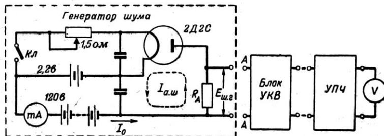
Рис. 31. Схема генератора шума для измерения коэффициента шума.
