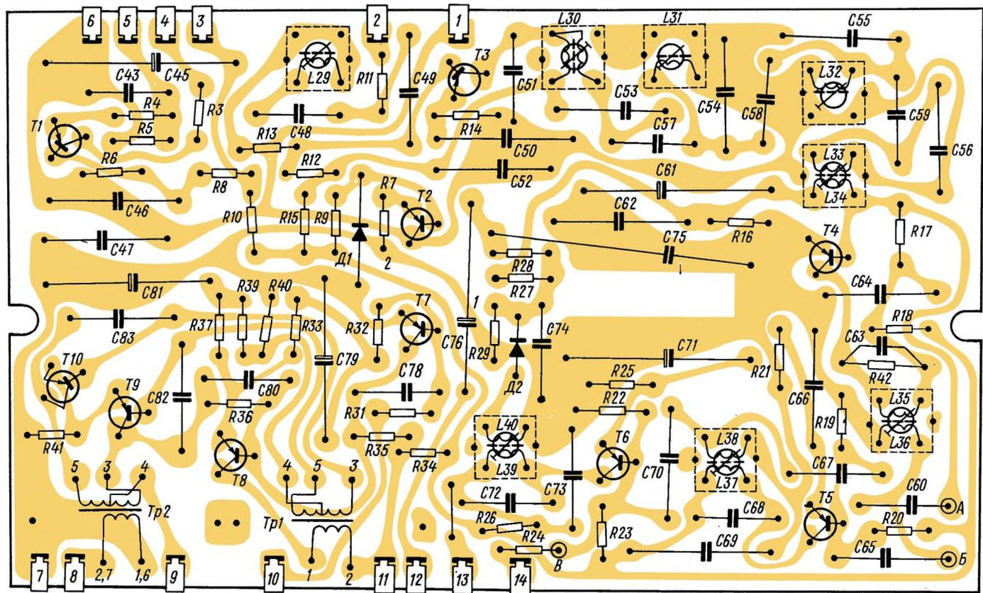
Рис. 2. Электромонтажная схема платы ПЧ-НЧ радиоприемников «Спидола», «ВЭФ-Спидола» и «ВЭФ-Спидола-10»
