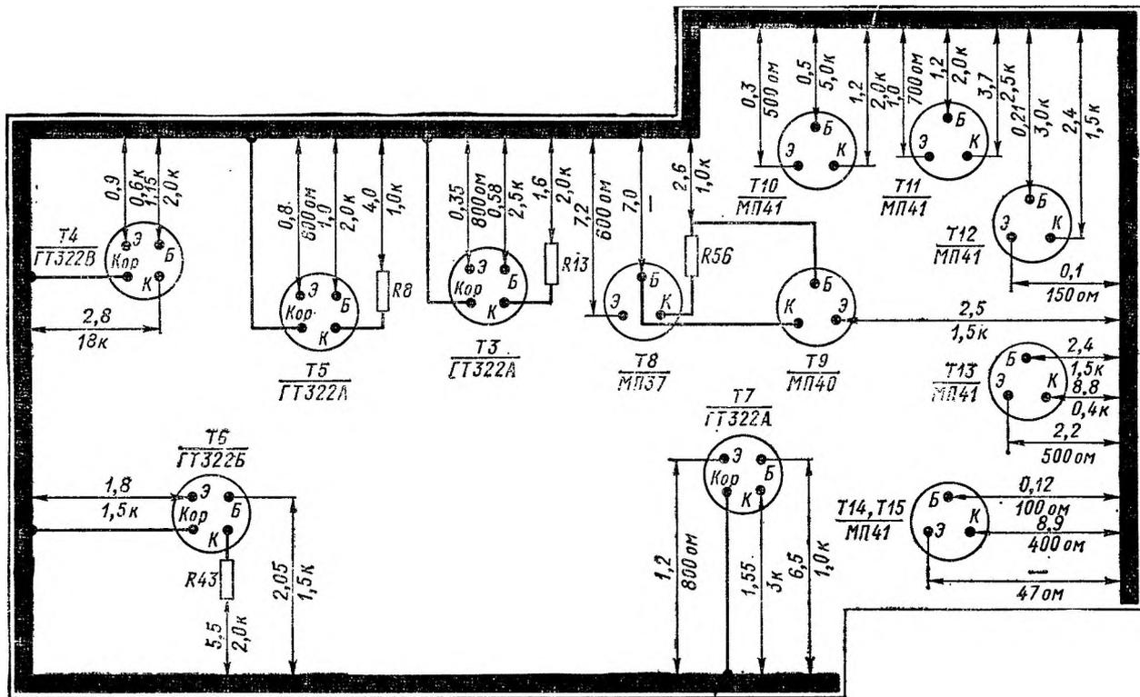
Рис. 67. Диаграмма напряжений и сопротивлений радиоприемника «Спидола-207»
