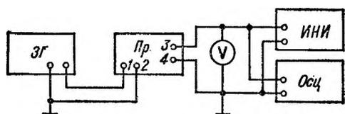
Рис. 69. Структурная схема настройки и проверки УНЧ приемников
