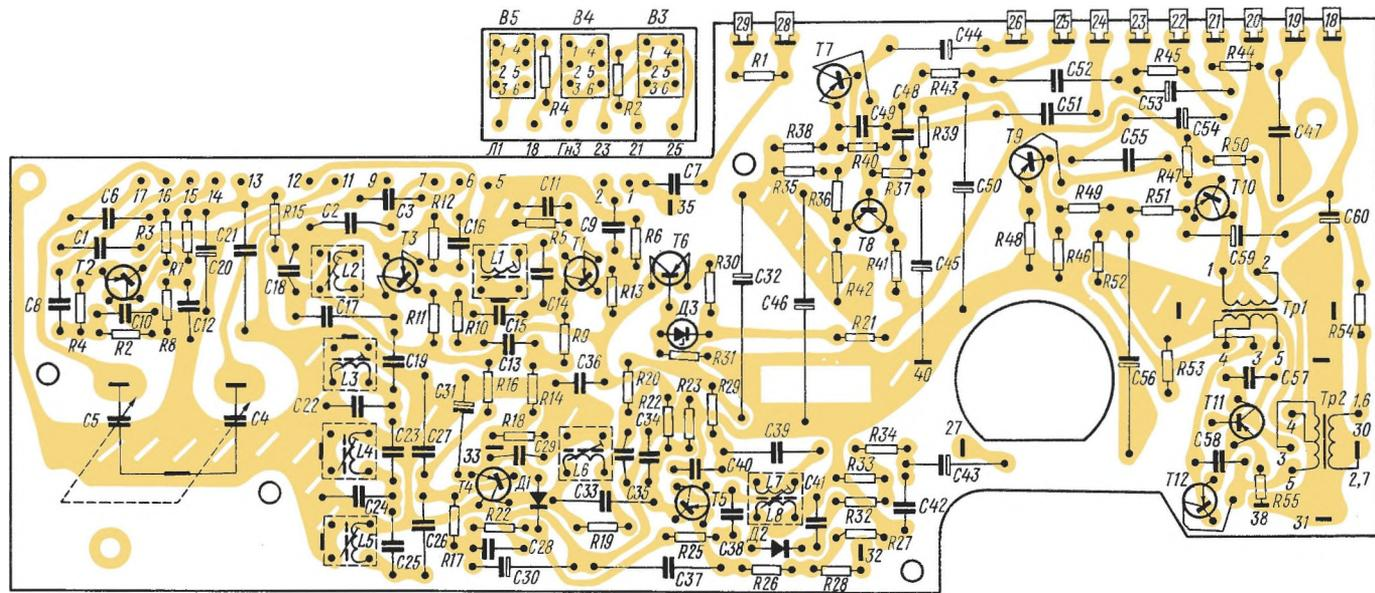
Рис. 30. Электромонтажная схема платы ПЧ-НЧ радиоприемника «Спидола-230»
