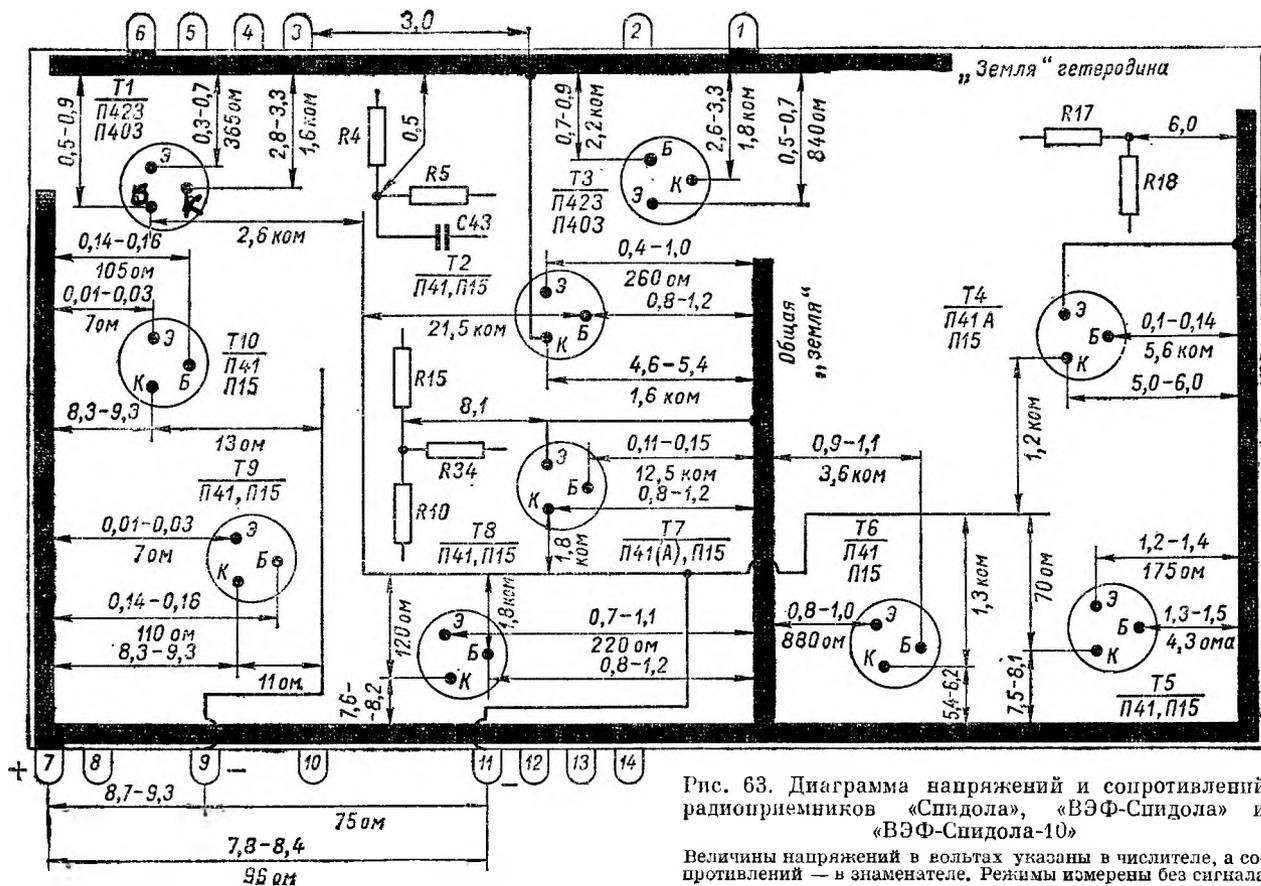
Рис. 63. Диаграмма напряжений и сопротивлений радиоприемников «Спидола», «ВЭФ-Спидола» и «ВЭФ-Спидола-10»
