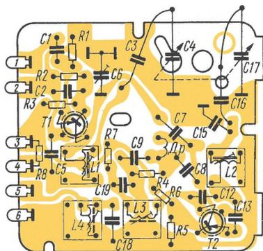
Рис. 16. Электромонтажная схема платы блока УКВ радиоприемника «Океан-203»
