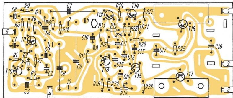
Рис. 13. Электромонтажная схема платы УНЧ радиоприемника «Океан»
