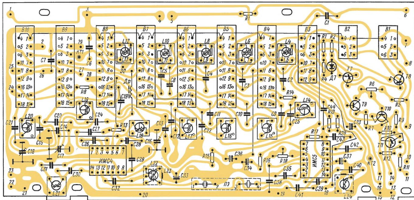
Рис. 34. Электромонтажная схема платы ВЧ-ПЧ АМ радиоприемника «Меридиан-202»
