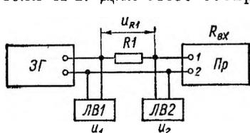
Рис. 70. Структурная схема измерения входного сопротивления УНЧ приемников
