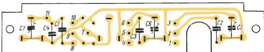
Рис. 35. Электромонтажная схема платы конденсаторов радиоприемника «Меридиан-202»
