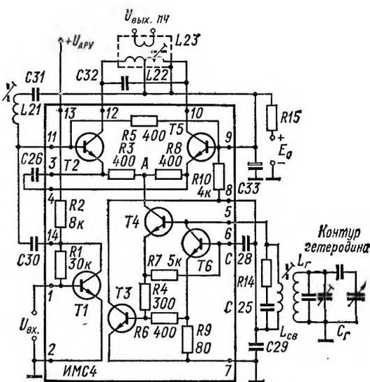
Рис. П-4. Принципиальная схема ИМС4 типа К2ЖА371 с внешними элементами подключения
