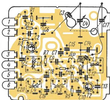
Рис. 11. Электромонтажная схема платы блока УКВ радиоприемника «Океан»
