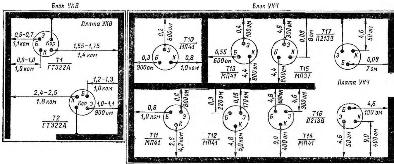
Рис. 65. Диаграмма напряжений и сопротивлений радиоприемников «Океан» и «Океан-203»
