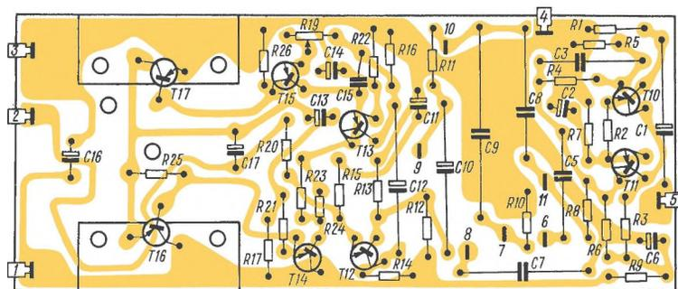
Рис. 18. Электромонтажная схема платы УНЧ радиоприемника «Океан-203»
