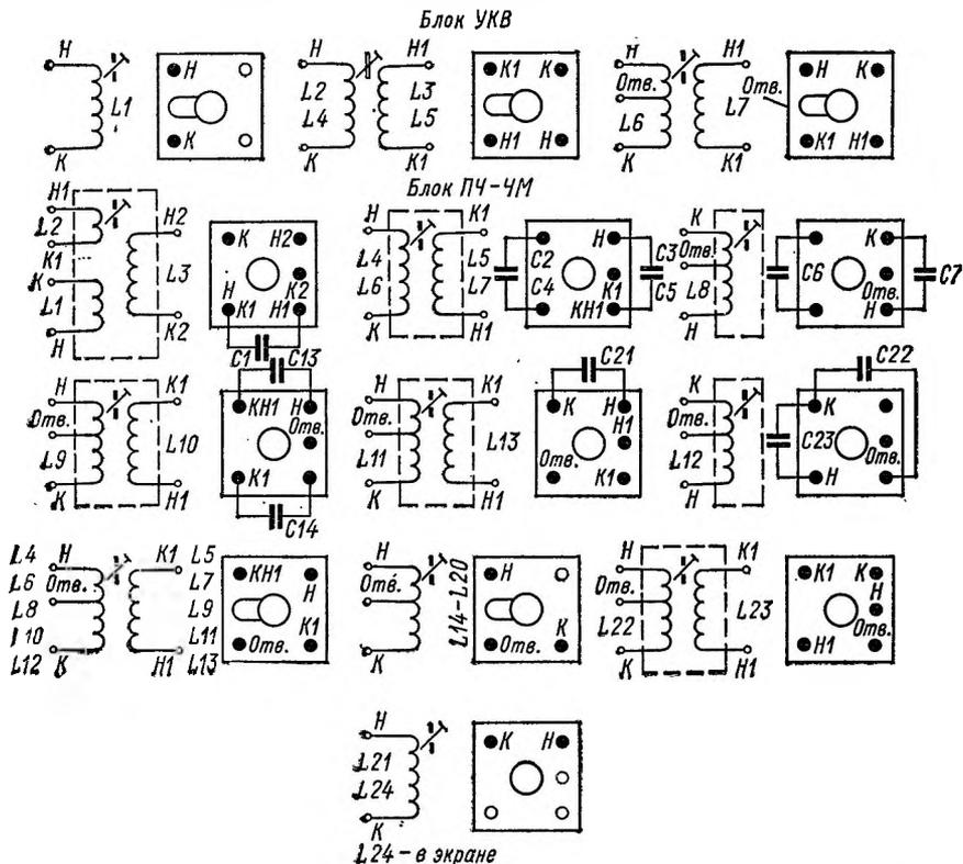
Рис. П-13. Распейка выводов катушек радиоприемника «Меридиан-202»
