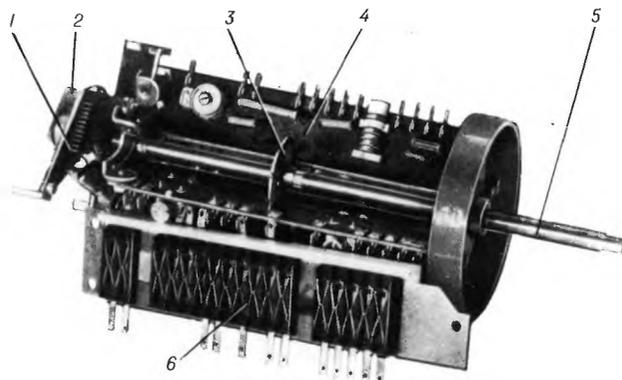
Рис. 56. Барабанный переключатель диапазонов радиоприемников «Спидола-207» и «Спидола-230»
