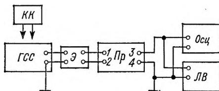
Рис. 76. Структурная схема проверки основных параметров приемников
