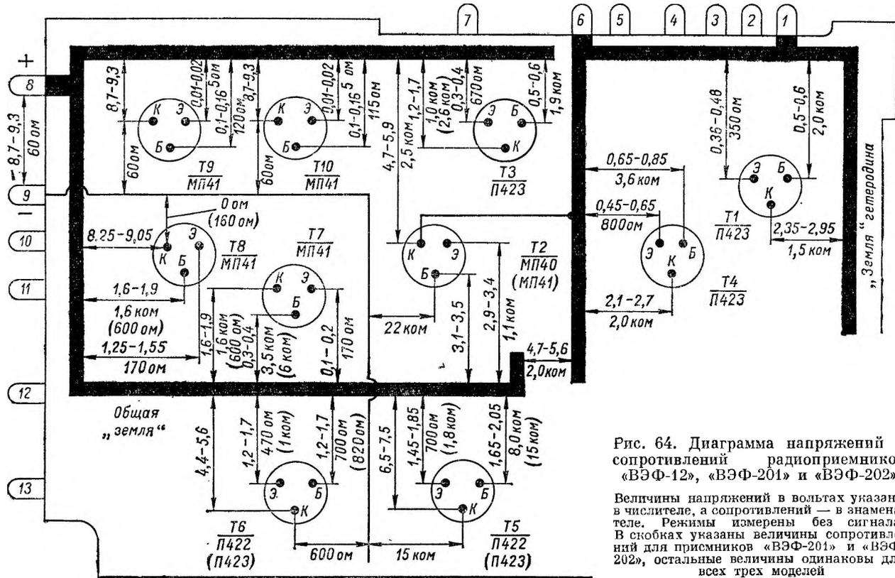
Рис. 64. Диаграмма напряжений и сопротивлений радиоприемников «ВЭФ-12», «ВЭФ-201» и «ВЭФ-202»
