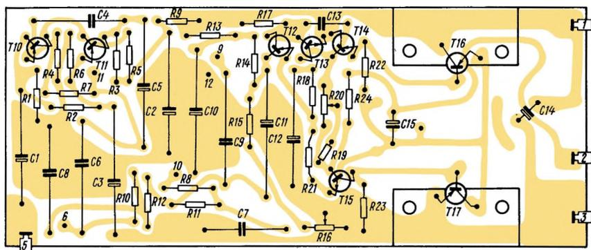
Рис. 21. Электромонтажная схема платы УНЧ радиоприемника «Океан-205»
