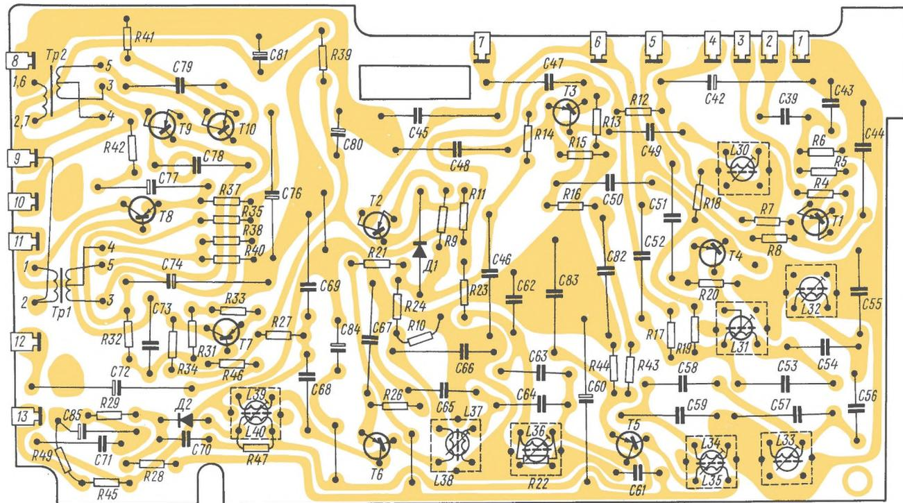
Рис. 6. Электромонтажная схема платы ПЧ-НЧ радиоприемников «ВЭФ-12», «ВЭФ-201» и «ВЭФ-202»
