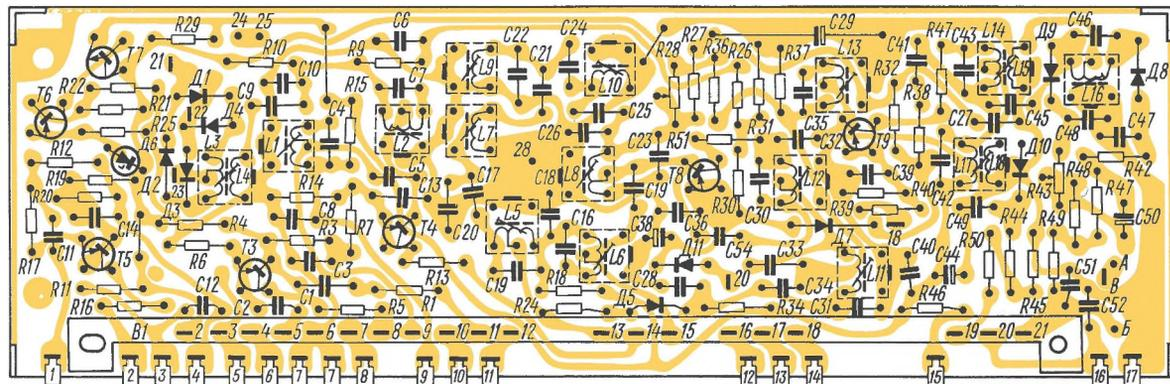
Рис. 17. Электромонтажная схема платы ВЧ-ПЧ радиоприемника «Океан-203»
