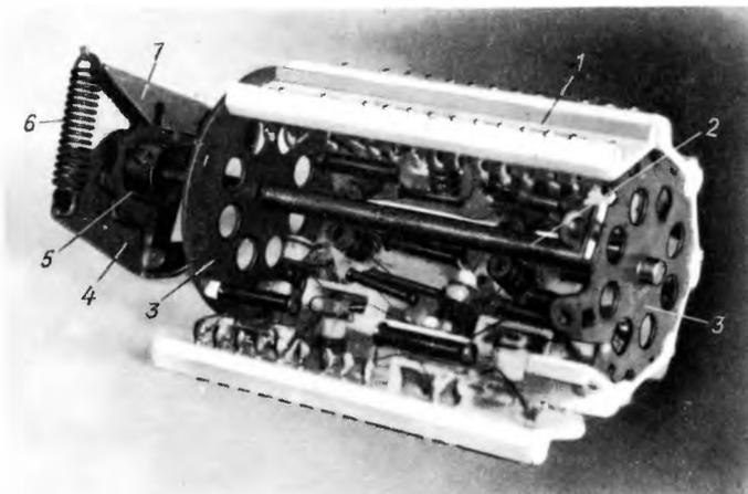
Рис. 39. Барабанный переключатель диапазонов радиоприемников «Спидола», «ВЭФ-Спидола» и «ВЭФ-Спидола-10»
