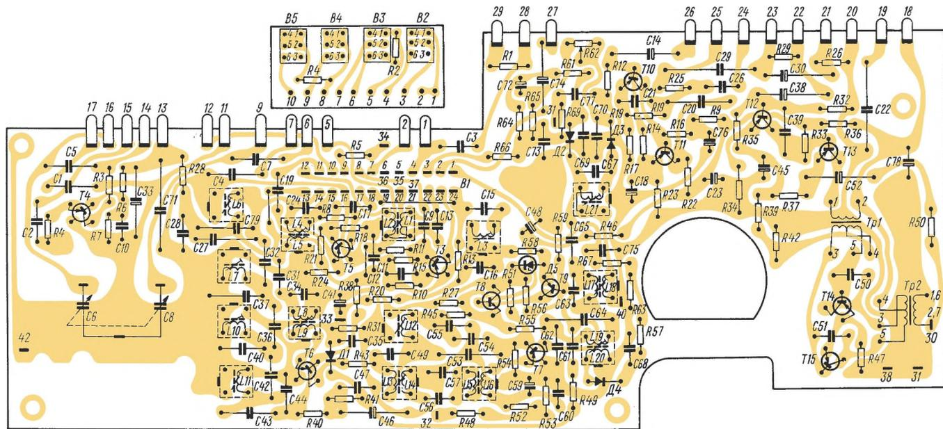
Рис. 28. Электромонтажная схема платы ПЧ-НЧ радиоприемника «Спидола-207»
