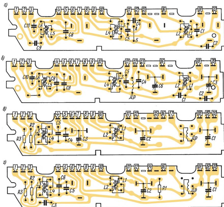
Рис. 24. Электромонтажные схемы планок диапазонов 25 м — П1, 31 м — П2, 41 м — П3, 49 м — П4(а); 50—75 м — П5(б); СВ — П6(в); ДВ — П7(г) радиоприемника «Океан-205»
