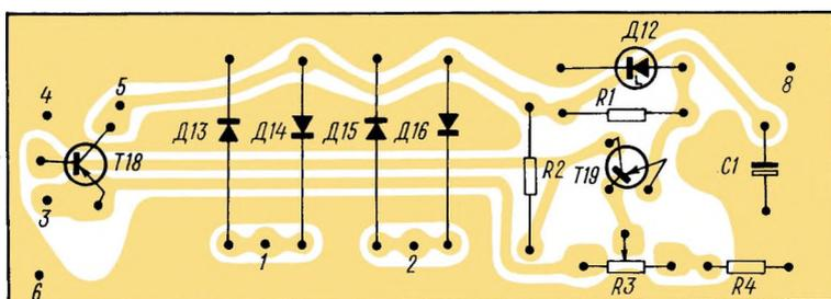
Рис. 22. Электромонтажная схема платы выпрямителя радиоприемника «Океан-205»
