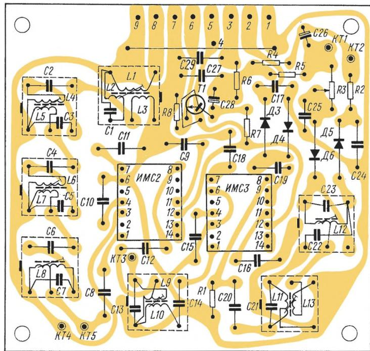
Рис. 33. Электромонтажная схема платы ПЧ-4М радиоприемника «Меридиан-202»
