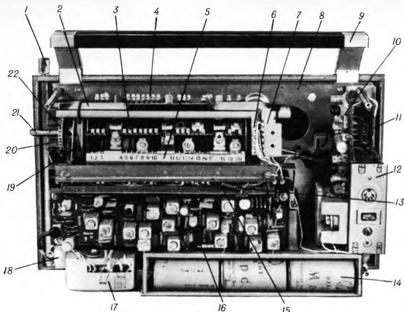
Рис. 53. Монтаж и размещение узлов радиоприемника «Океан-205»
