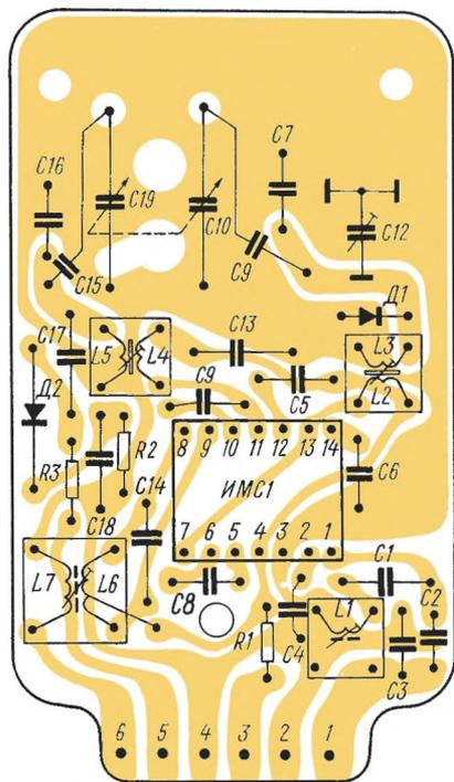
Рис. 32. Электромонтажная схема платы блока УКВ радиоприемника «Меридиан-202»
