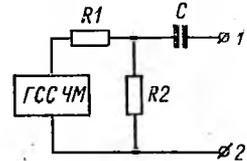
Рис. 74. Делитель для подключения ГСС ЧМ к схеме тракта УКВ радиоприемника «Меридиан-202»
