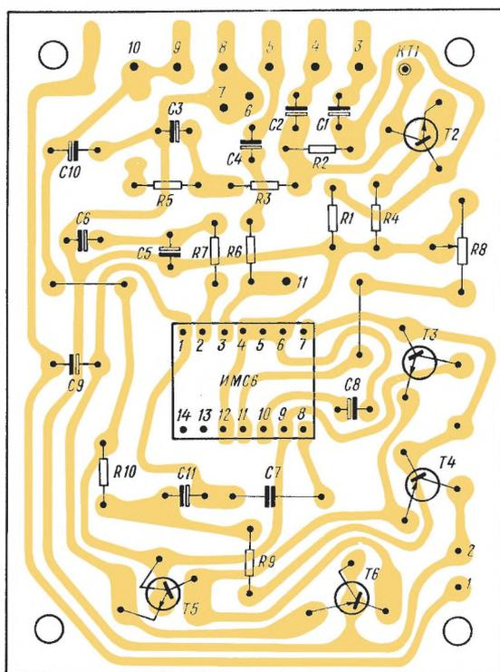
Рис. 36. Электромонтажная схема плат УНЧ и РС радиоприемника «Меридиан-202»
