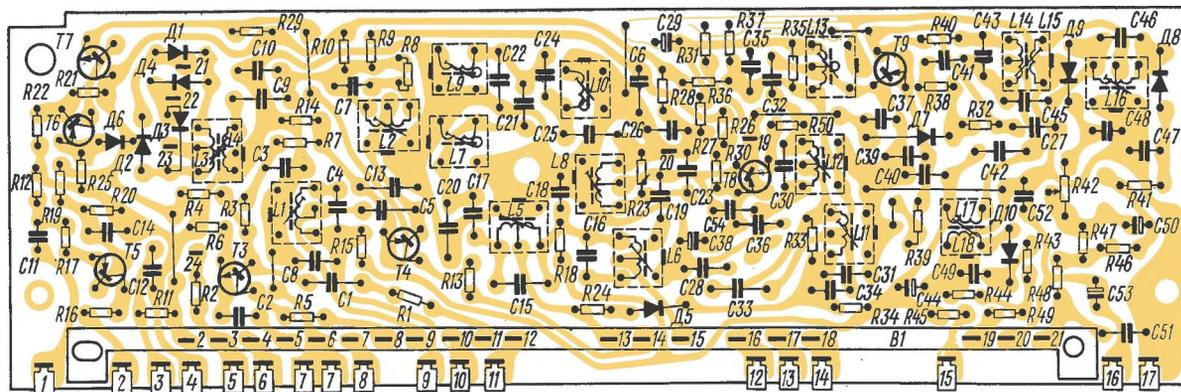
Рис. 12. Электромонтажная схема платы ВЧ-ПЧ радиоприемника «Океан»
