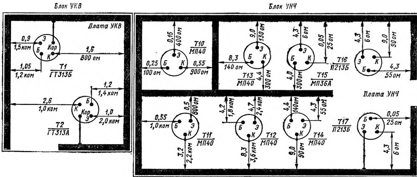
Рис. 66. Диаграмма напряжений и сопротивлений радиоприемника «Океан-205»
