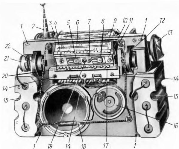
Рис. 38. Шасси радиоприемника «Спидола» в сборе (вид спереди)
