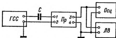
Рис. 71. Структурная схема настройки и проверки УПЧ приемников
