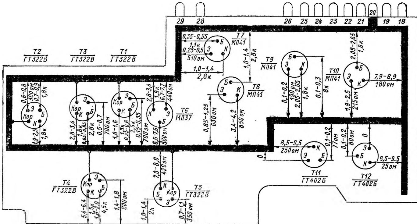
Рис. 68. Диаграмма напряжений и сопротивлений радиоприемника «Спидола-230»
