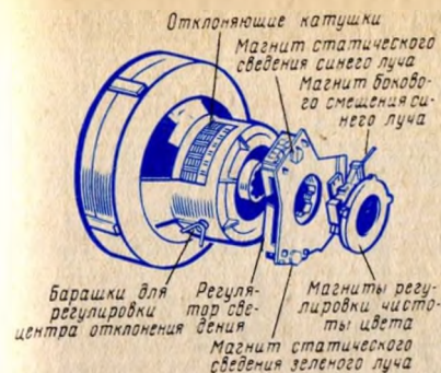
Рис. 6.26. Устройства, управляющие положением электронных лучей в кинескопе цветного изображения
